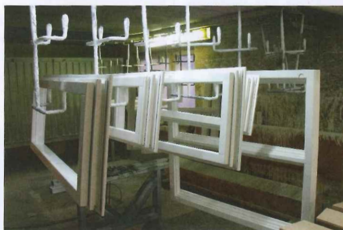
Fertig lackierte Fenster.
