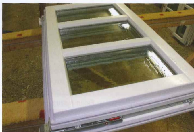
Versiegelung mit MultiSil Silicondichtstoff.
